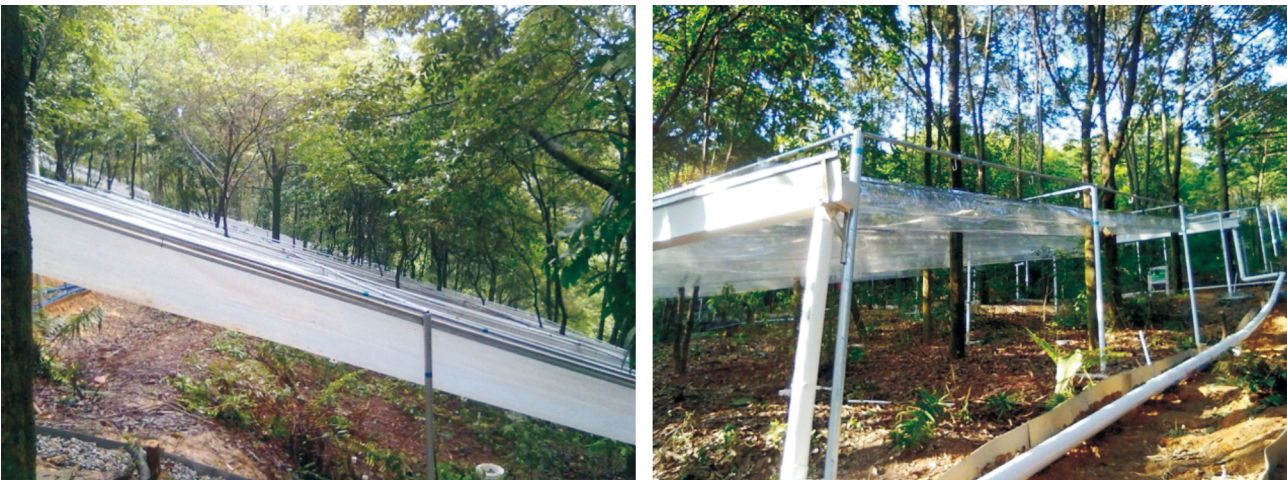
图 2 降水季节变化(PSDC)试验平台遮雨和支撑装置示意图
